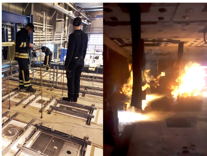
Visar ett brandtest av Furhoffs Rostfria ABs golvbrunnar.
