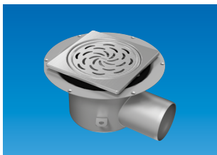
GOLVBRUNN FURU 006: Rostfri kvalitet EN 1.4301, sido- eller bottenutlopp.
