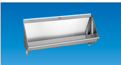
VÄGGURINAL FR 602: Syrafast kvalitet EN 1.4404, vänster- eller högerplacerat avlopp, längd 1200 mm, 1800 mm.
