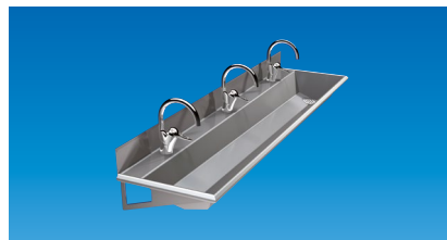
TVÄTTRÄNNA FR 405: Rostfri kvalitet EN 1.4301, vänster- eller högerplacerat avlopp, längd 1200 mm, 1800 mm, 2400 mm, 3000 mm.
