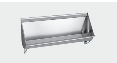
VÄGGURINAL FURO 602: Syrafast kvalitet EN 1.4404, vänster- eller högerplacerat avlopp, längd 1200 mm, 1800 mm.
