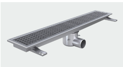
SMAL GOLVRÄNNA FURO 115: Syrafast kvalitet EN 1.4404, sido- eller botten- utlopp, storlek 500 x 150, 800 x 150, 900 x 150 mm, 1000 x 150 mm, 1100 x 150 mm, 1200 x 150 mm, 1300 x 150 mm, 1400 x 150 mm, 1500 x 150 mm, 2000 x 150 mm.
