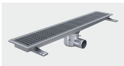
SMAL GULVRENNE FURO 115: Syrefast kvalitet EN 1.4404, side- eller bunn- utløp. Bredde 150 mm og lengde 800 mm, 900 mm, 1000 mm, 1100 mm, 1200 mm, 1300 mm, 1400 mm, 1500 mm og 2000 mm.
