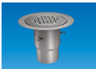
GULVSLUK FURO 007: Syrefast kvalitet EN 1.4404, side- eller bunnutløp.
