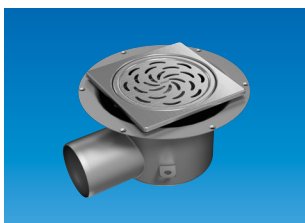
GULVSLUK FURO 006: Rustfri kvalitet EN 1.4301, side- eller bunnutløp.
